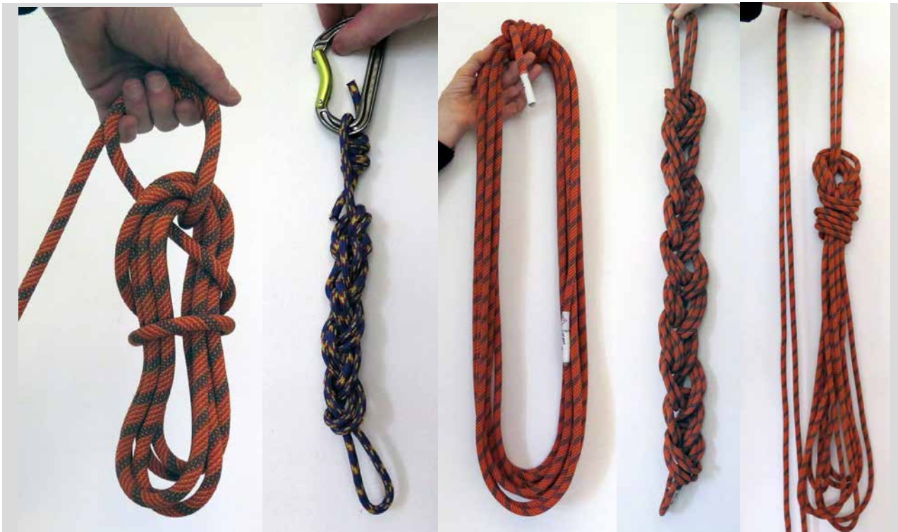
Fra venstre: Kastebundt, fingerhækket prusikslynge, Alpint rebkvejl, fingerhækket reb (klar til at hænge til tørre), Rebkvejl efter "rygsæk" metoden.
