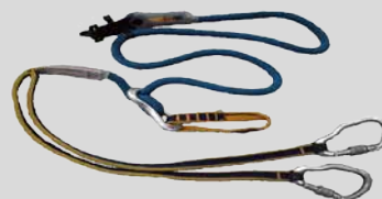
Y-type Via-ferrata sikring med fald-dæmper som et ekstra stykke reb, der ved styrt trækkes igennem en rebbremse.
