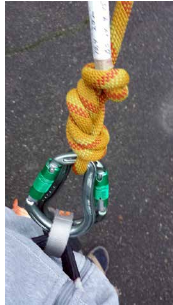
To modsat vendte karabiner. Dobbelt ottetal med stopknude (fisker knob) om egen part som ekstra backup.
