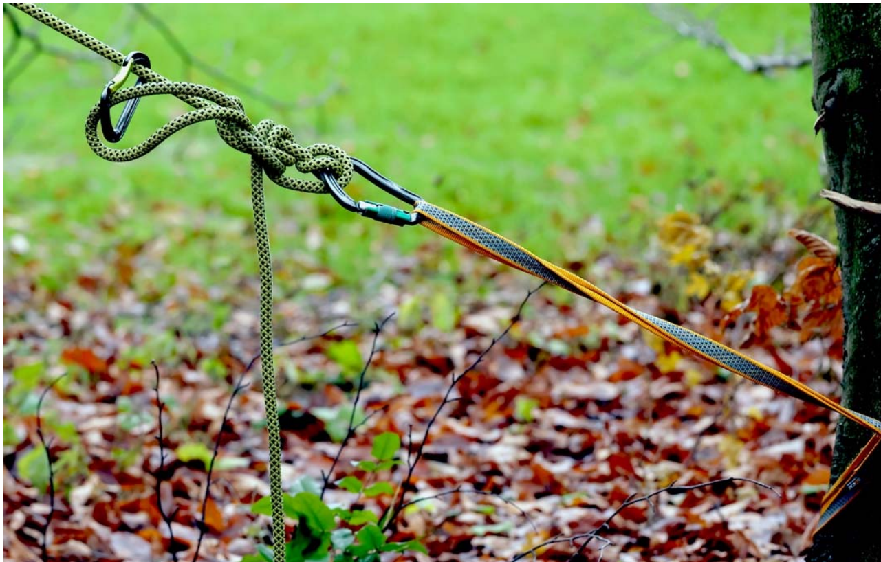
Nedsænkbart redningsreb etableret med HMS og afbundet med dobbelt halvstik
